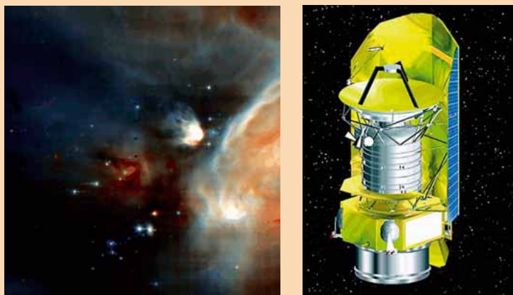
À droite : une vue d'artiste du satellite Herschel dont le télescope et l'instrumentation ont été placés au-dessus d'un réservoir d'hélium. À gauche : Herschel étudiera les sites de formation d'étoiles dans une gamme d'énergie inexplorée (image de Rho Ophiucius vue par le satellite ISO).
