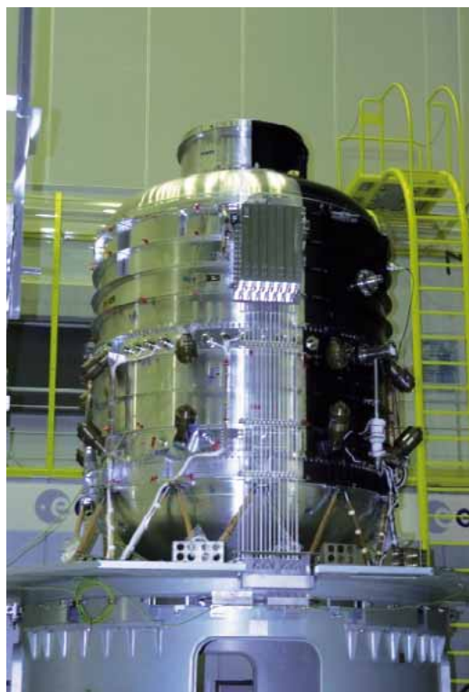
Le cryostat d'Herschel contient 2 500 litres d'Hélium, ce qui assure à la mission une autonomie d'environ 3 ans. Il maintient l'ensemble du plan focal à une température de -271^{\circ}\text{C} . Le télescope est, quant à lui, refroidi passivement à -200^{\circ}\text{C} grâce à une protection thermique.
